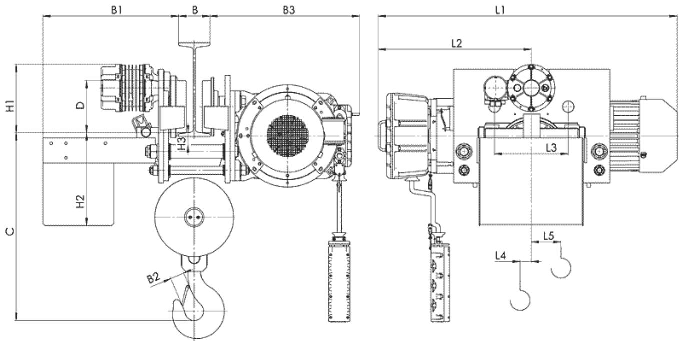
**Канатный электротельфер ВТ78 Уменьшенная строительная высота, полиспаст 4/1**
